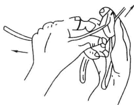
图 1-4 用钢丝钳勒去导线绝缘层
