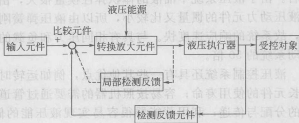
图 2-3 液压伺服系统的构成
