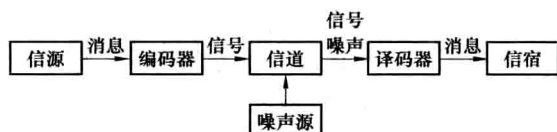
图 1.2 通信系统一般模型
