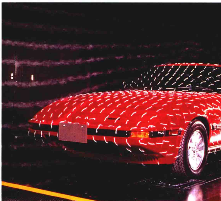
新车样品在风洞中进行空气动力学检测。图中的烟雾形迹显示了流过汽车的气流。一段段线条显示了汽车表面附近的气流。
