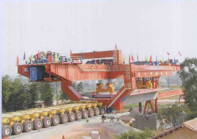
900T 箱梁运架一体机
