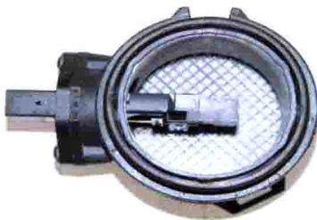
图6 热膜式空气流量传感器的结构
