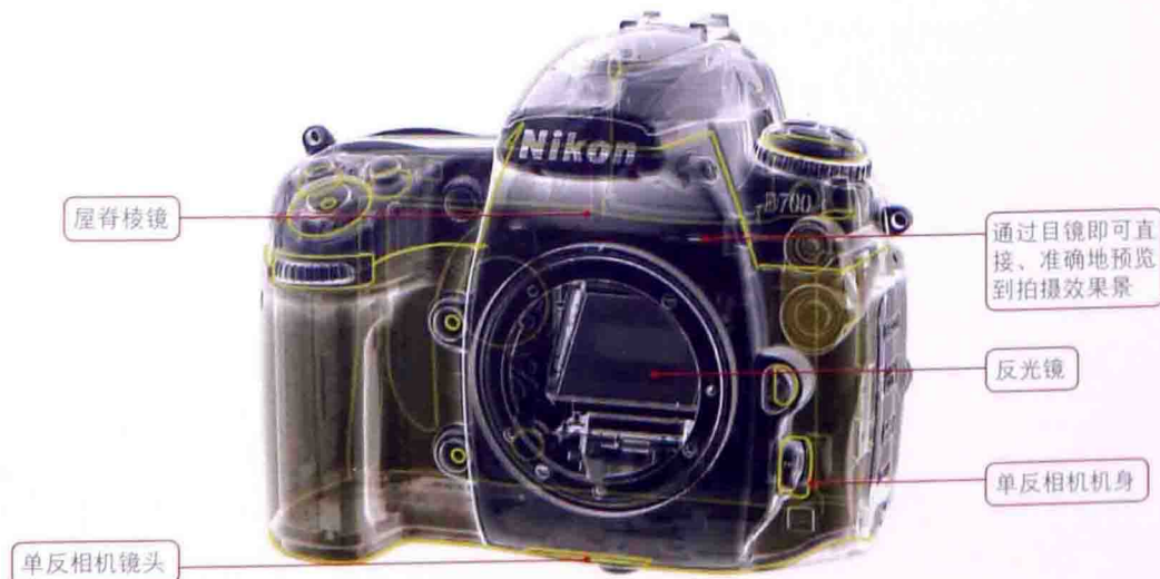
▲ Nikon 数码单反相机内部结构和工作原理
