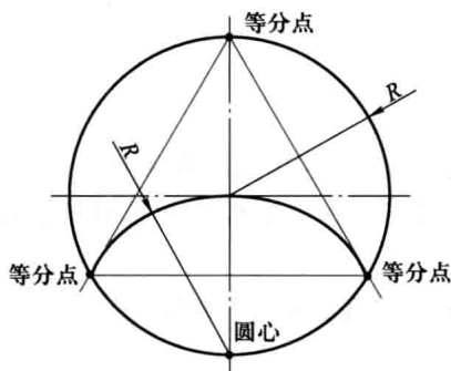
图 1-12 作圆内接正三角形
