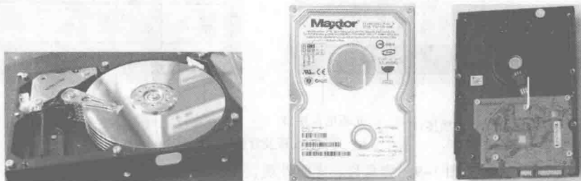
图 1-6 硬盘内部结构及外观
