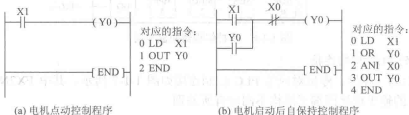
图 1-1-8 电动机点动控制及启动后自保持运行控制程序
