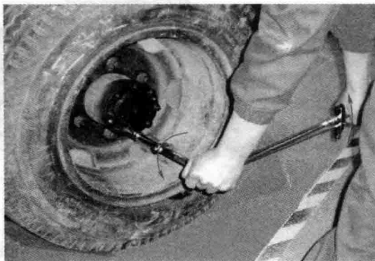
图 1-24 拧松半轴固定螺栓的螺母
