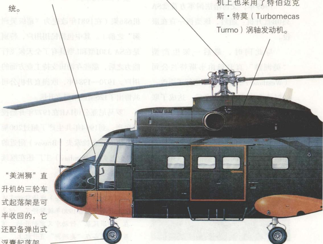
“美洲狮”直升机的三轮车式起落架是可半收回的，它还配备弹出式浮囊起落架。
