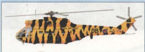
■ 爱尔兰空军SA 330J：这架单独的由爱尔兰空军使用的SA 330J直升机是一架转换为民用型的直升机，配有标准的气象雷达设备，被用于军队和贵宾的运输。
