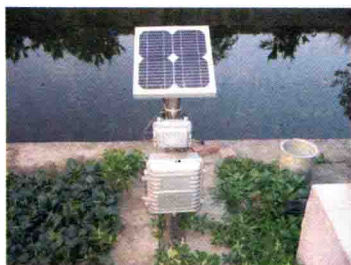
设置在河边和厂矿企业排污口的水质自动化采样监测仪器
