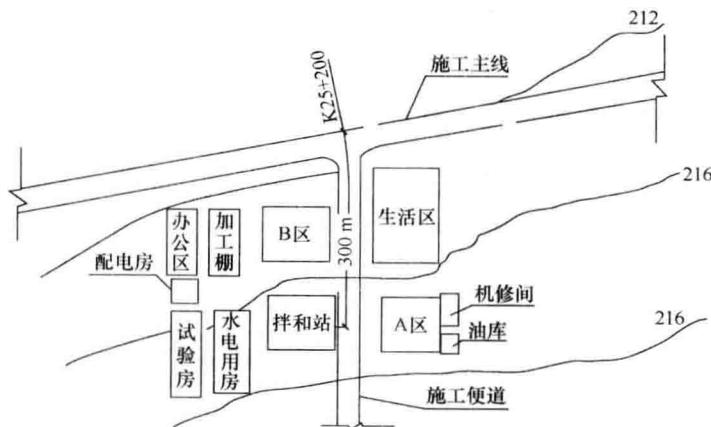
图中拌和站由物料储存系统、搅拌主机和电气控制系统以及其他附属设施等组成。
