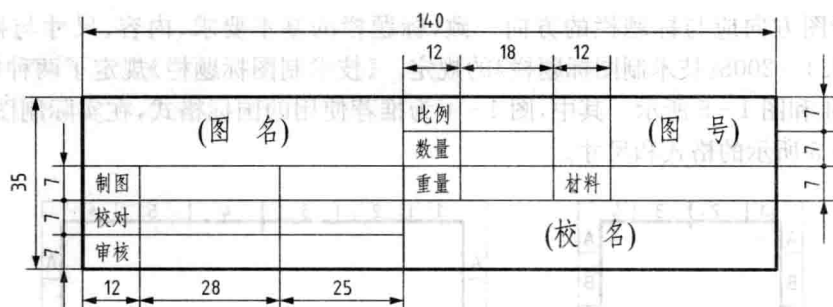
图 1-5 制图作业用标题栏的格式
