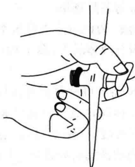
图 1-6 酸式滴定管的操作
