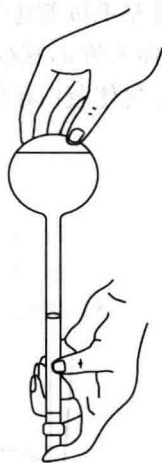
图 1-10 检查漏水和混匀溶液的操作
