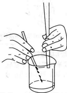
图 1-9 在烧杯中的滴定操作
