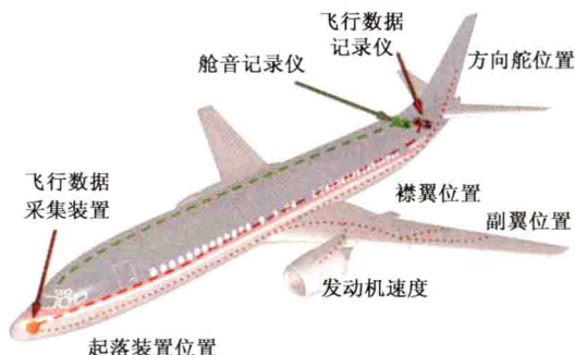
图 1-6 飞行记录仪安装位置
