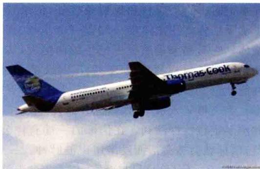
图 1-5 白雾为泄漏的燃油
