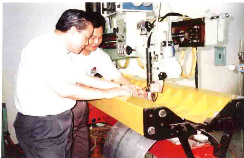
1996 年，关桥（前）和研究生张崇显（后）讨论采用“热源—热沉”局域 热拉伸效应实现低应力无变形焊接
