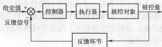
图 1-6 闭环控制系统方框图
