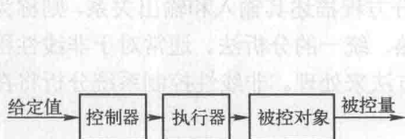
图 1-5 开环控制系统原理方框图
