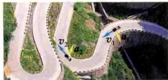
图 1-7 小车作一般曲线运动时, 其加速度的方向总是指向轨道曲线凹的一侧
