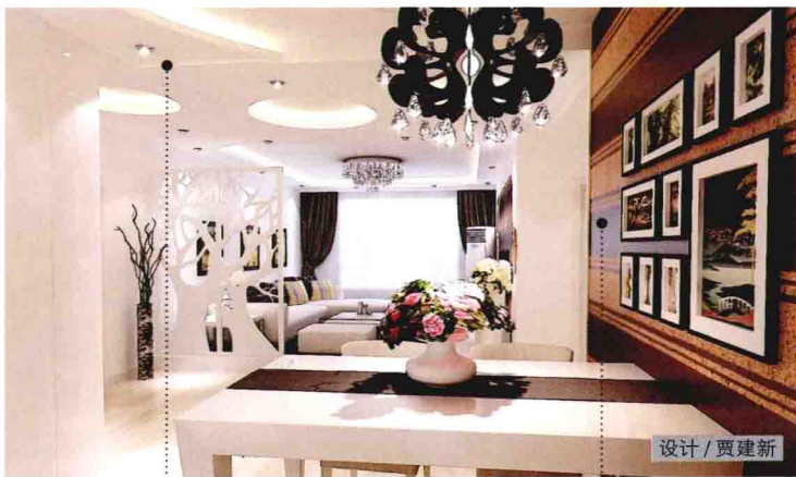
石膏板造型吊顶内藏灯带
