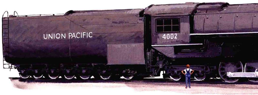
这是1941年美国制造的“大男孩”。它是当时世界上马力最大的蒸汽机车，也是体积最大和分量最重（长41米，重540吨）的蒸汽机车。
