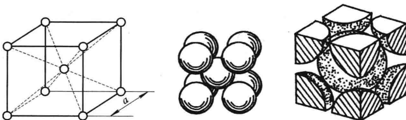
图 1-2 体心立方晶格示意图
