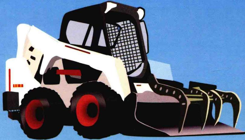
美国山猫旗下的S650滑移转向装载机是目前世界上最大的滑移装载机。它的操作重量达到3.7吨，额定载荷1.2吨，倾翻载荷2.4吨。
