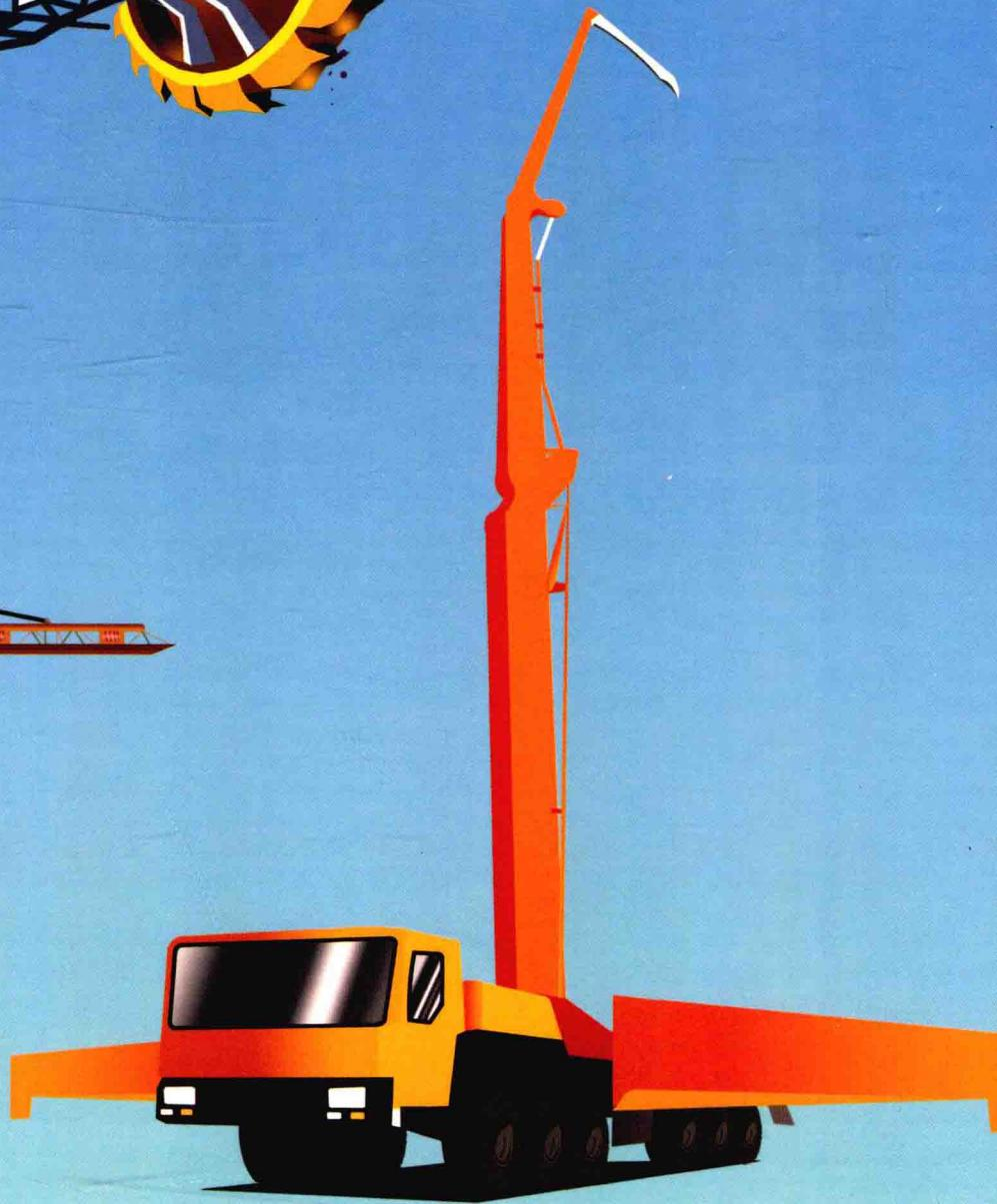
世界上最长臂架泵车是三一重工的86米泵车，世界首创7节臂设计，9桥全路面底盘，轻松实现公路快速行驶，可在狭小和崎岖场地作业。
