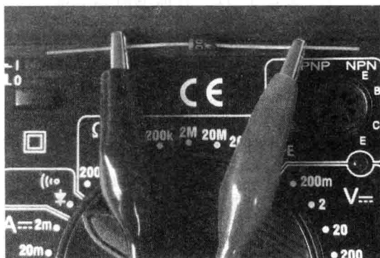
图 1.1.7 数字万用表测量普通二极管
