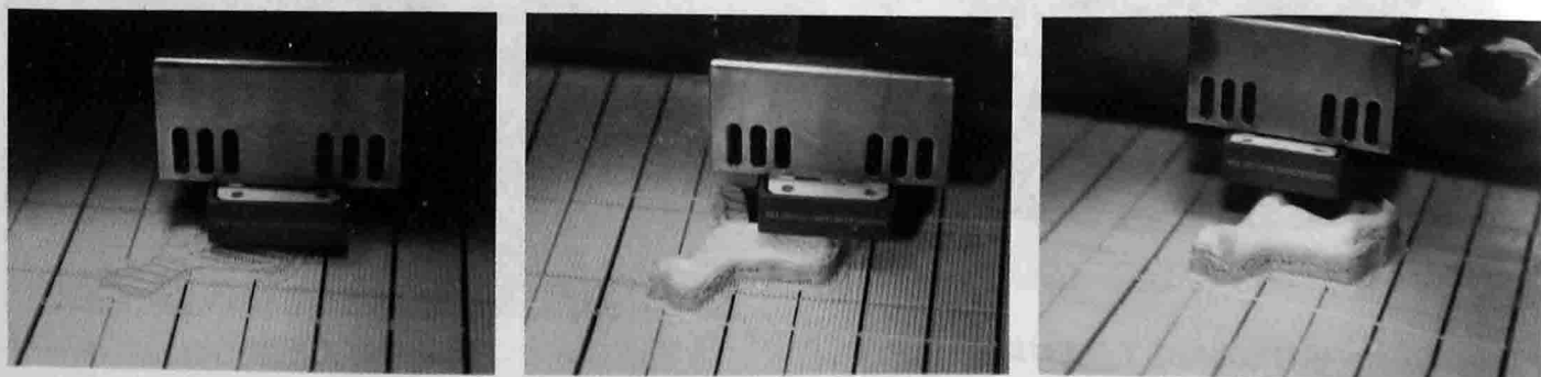
图1.1.7 堆叠打印的过程
