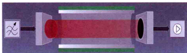
图 1-25 调制器将数字信号变为光信号传输
