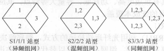
图 1-4 定向站型多频点配置示意图
