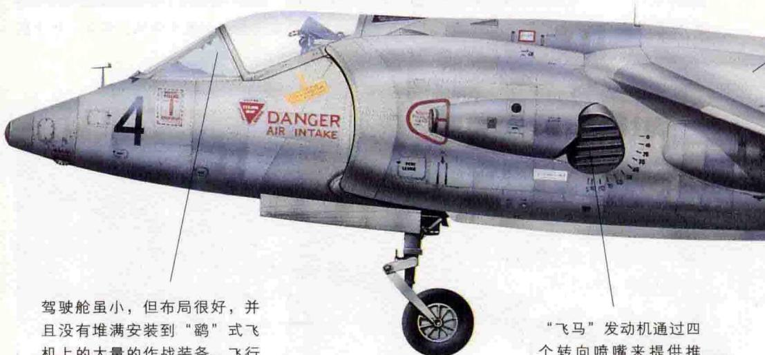
驾驶舱虽小，但布局很好，并且没有堆满安装到“鹞”式飞机上的大量的作战装备。飞行员坐在一个马丁-贝克弹射座椅上，在P.1127飞机的试飞中实际上是由两名飞行员在操作。
