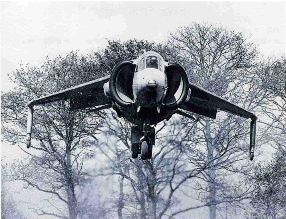
▲ 能悬停的“红隼”飞机不是没有危险。如果该机在低的前飞速度上发生偏航，那么可能造成恶性滚转，而这是无法修正的。
