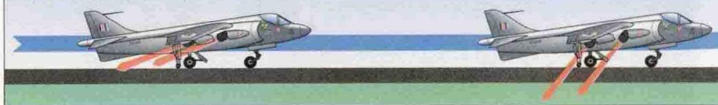
**2** 垂直推力：加速向前，飞行员猛地把飞机的喷嘴推到55°。这足以把飞机提升到空中。
