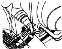
图 1.17 拔下电动冷却风扇电线接头、 散热器左侧热敏开关接头
