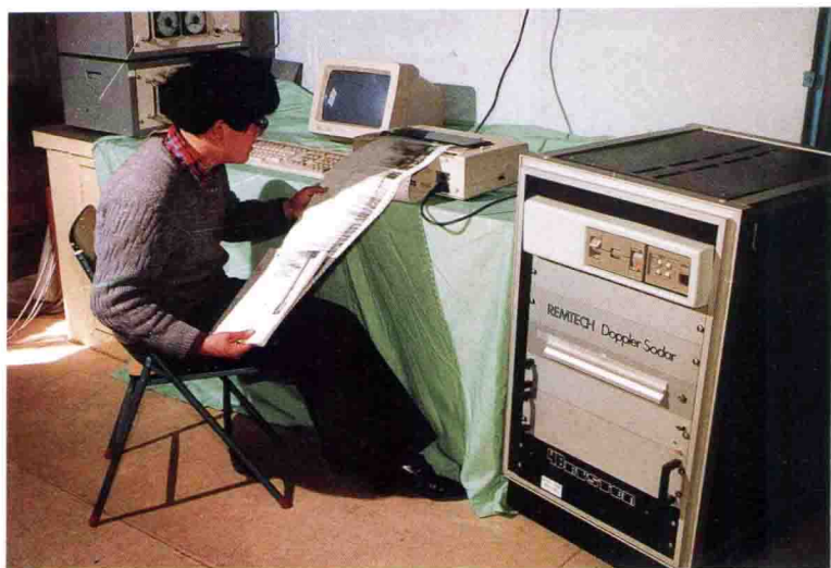
应用多普勒测风声雷达进行环保监测
