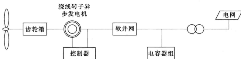
图 1-2 绕线转子异步发电机工作原理图
