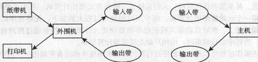
图 1.3 脱机输入/输出方式
