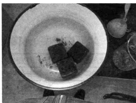
图 1.4 砂岩吸水率实验
