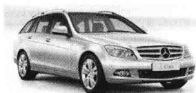
旅行车 Station wagon 采用三厢车设计的两厢车，行李舱和驾驶室为一体，提高货物存放能力。
