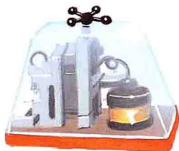
地震检波器，能够探测地下几百米深处发生的震动。
