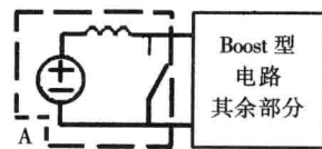
图 1(a) DC/DC Boost 型变换器
