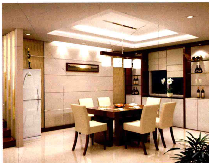
大芯板造型 石膏板拓缝 石膏板造型
