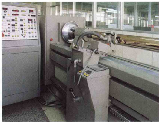
图 1-24 凹版电雕机——电雕版辊生产
