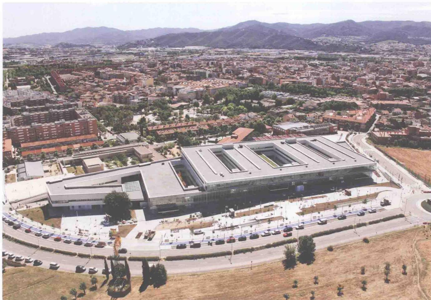
开发这三项标准。例如，利用地热、辐射顶棚采暖、太阳能光热板，减少水电消耗以及对设施进行控制和管理。同时，它也提高了立面、屋顶和天井的惰性以及隔热性，提供自然通风和照明。
