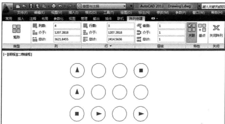
对于每种类型的阵列（矩形、环形和路径），可以在上下文功能区选项卡以及命令行中修改阵列的值，还可以使用阵列对象上的多功能夹点动态编辑相关的特性，如下图所示。按 Ctrl 键循环浏览具有多个选项的夹点。
