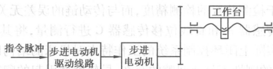
图 1-3 开环控制数控机床的工作原理图
