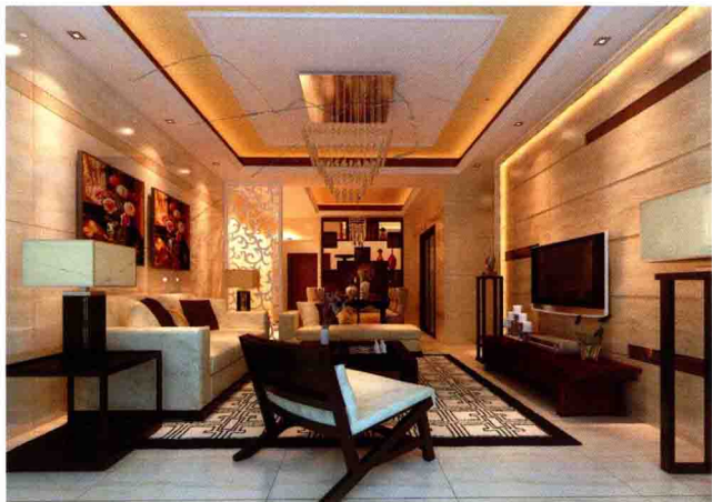
◎顶面 / 实木线收边 + 墙纸 电视墙 / 木纹大理石 + 茶镜
