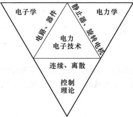
图 1.1 描述电力电子学的倒三角形
