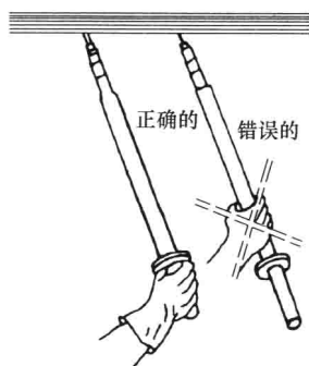
图 1-4 10kV 高压验电器使用方法
