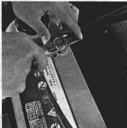
图 1-2 拆开蓄电池负极电缆固定夹
