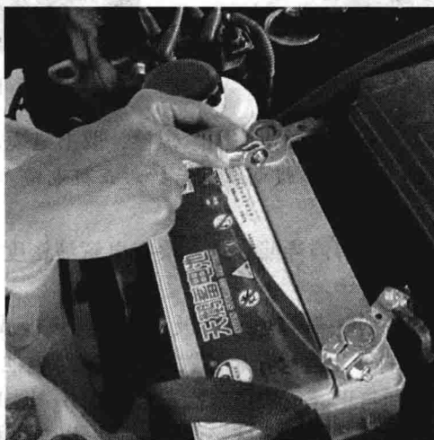
图 1-7 安装蓄电池负极电缆固定夹
