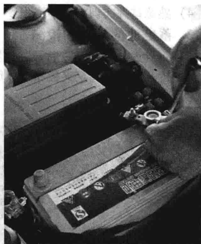
图 1-6 安装蓄电池正极电缆固定夹
