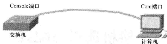
图 1-1 交换机基本配置网络拓扑图
