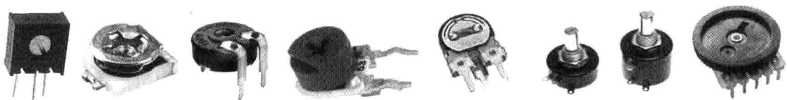
图 1-3 常见可调电阻（电位器）的实物外形
