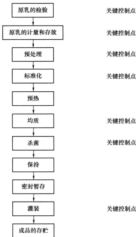
图 2-1 巴氏乳生产工艺流程与关键控制点
