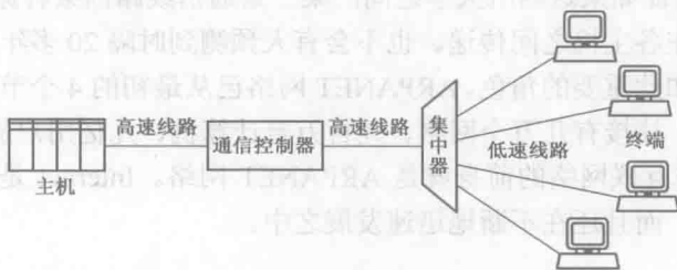
图 1-3 利用通信控制器实现通信
